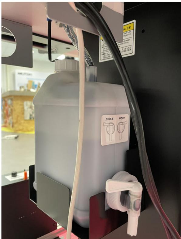
El dispositivo cuenta con un contador de tinta residual que avisa al usuario de cuándo hay que vaciar el bote de tinta residual. A diferencia de algunos dispositivos, el usuario no retira la botella de tinta, sino que hay un grifo de drenaje y el usuario simplemente pone otro recipiente bajo el grifo, abre y drena la botella de tinta, evitando así la necesidad de manipular el tubo de tinta residual en absoluto.
