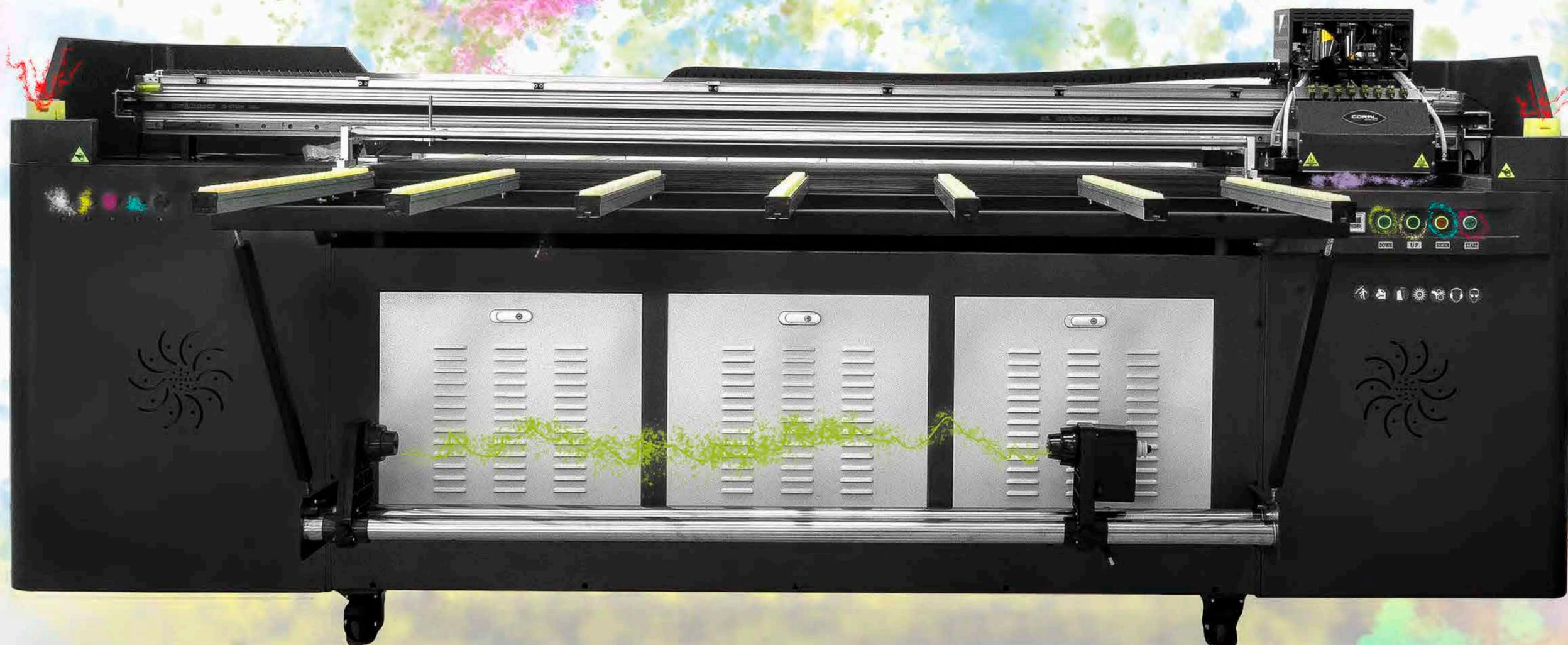
El área de impresión es de 180 cm de ancho con un espesor del material de 6 cm como máximo.
